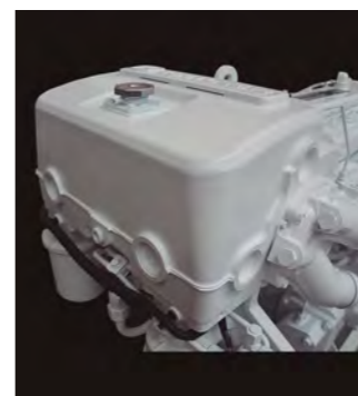
Intercambiador abierto agua-agua
