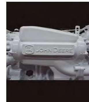
Múltiple de escape refrigerado por agua
