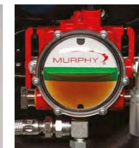
Sistema de mantenimiento de nivel de aceite
