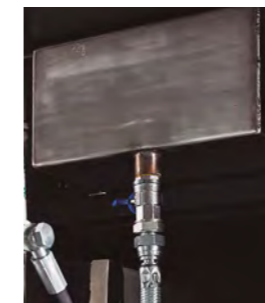
Depósito de aceite para rellenado automático
