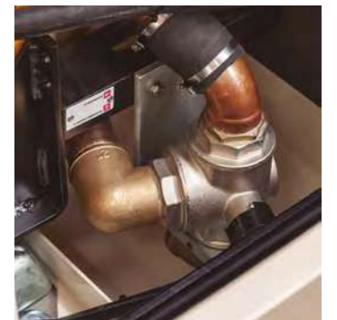
Válvula de selección para refrigeración por radiador/quilla
