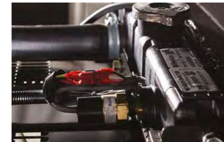
Sensor del nivel de refrigerante en radiador
