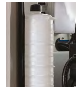
Depósito de agua destilada
